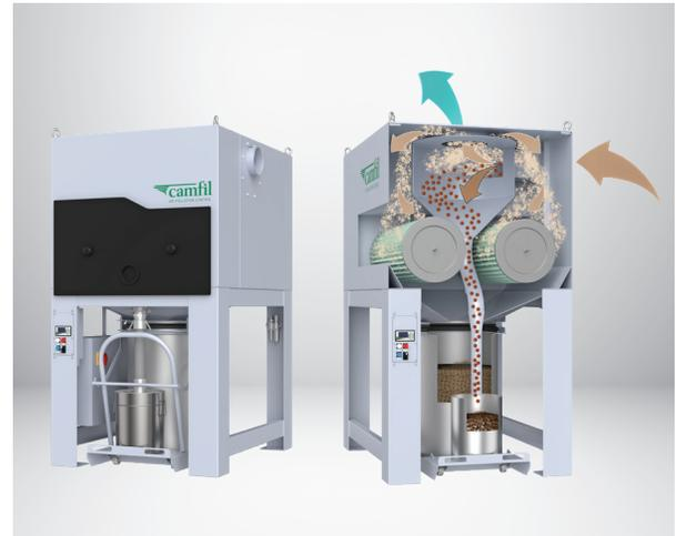
Captador de polvo compacto QS2 de la serie Quantum, diseñado específicamente para la captación de mesas láser individuales. Unidades disponibles en tres tamaños diferentes con volúmenes de aire de 1.500 a 5.500 m<sup>3</sup>/h.
