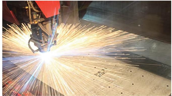
Una pieza promocional de Camfil APC se fabrica en una mesa láser de 4 KW.
