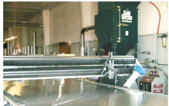
Esta mesa de corte por plasma en seco se sirve de un captador de polvo y humos de cartucho adyacente para mantener la limpieza del aire.
