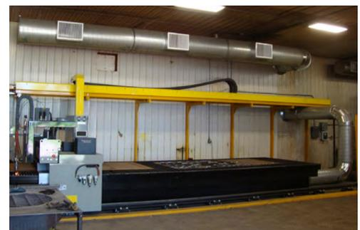
Ejemplo de mesa de tiro descendente seco: Los contaminantes se expulsan a un captador de polvo seco exterior que captura el polvo y humos.
