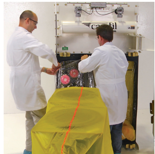
"Bag-In/Bag-Out" (BIBO) Filterwechsel im Rahmen eines Tests mit Ersatzstoffen. Diese Tests erlauben es, die Leistung von Entstaubungssystemen in Containment-Anwendungen zu ermitteln.
