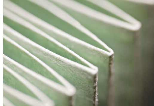
Filterpatronen mit weiter Faltung sorgen für einen besseren Luftstrom and eine größere Staubaufnahme.
