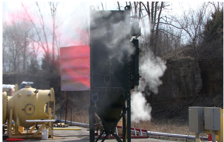
Mit einer kontrollierten Explosion wird überprüft, ob die Druckentlastung richtig funktioniert. Hier wurde der Explosionsdruck aus dem Inneren abgeleitet und eine Zerstörung der Entstaubungsanlage durch die Staubexplosion verhindert.
